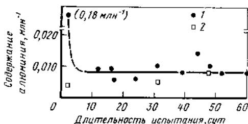
Рис. 7.18. Растворение алюминия в деионизированной воде (по данным Alcoa Laboratories ): 1 – образцы из испытательной камеры с водой; 2 – образцы непосредственно из деионизатора
