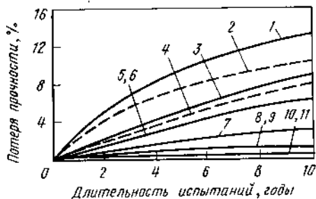
Рис. 7.1. Влияние атмосферных условий на коррозионную стойкость листов из алюминиевых сплавов (усредненные данные для сплавов 1100 и 3003) при выдержке на станциях:
